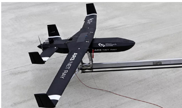
С помощью пускового устройства – катапульты, с платформы – без аэродромный старт
